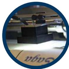
Registro por cámara CCD para detectar marcas y asegurar un corte perfecto.
