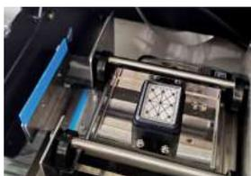
*Plataforma de limpieza de de un cabezal: Garantiza una limpieza eficiente y estabilidad en el flujo de trabajo.*
