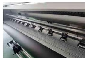
*Doble pinch roller + mesa de vacío: Ofrece una alimentación estable y mejora la precisión a la hora de imprimir.*
