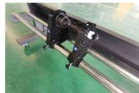
*Recolector de material automático: Permite mantener una impresión continua, estable y veloz.*
