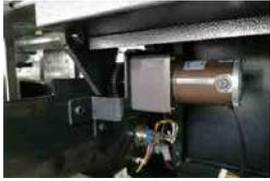
**Sistema eléctrico de elevación de los rodillos de presión:** Es fácil de operar y mejora notablemente la estabilidad y precisión al momento de imprimir.
