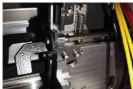
**Ajuste de la altura del carro de cabezales:** Fácil de regular y ajustar la altura del carro de cabezales a la hora de imprimir en distintos espesores.
