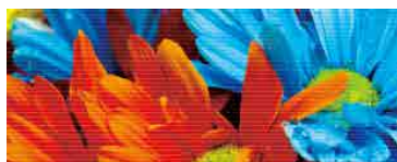
La falta de boquillas en el cabezal provoca bandas.
